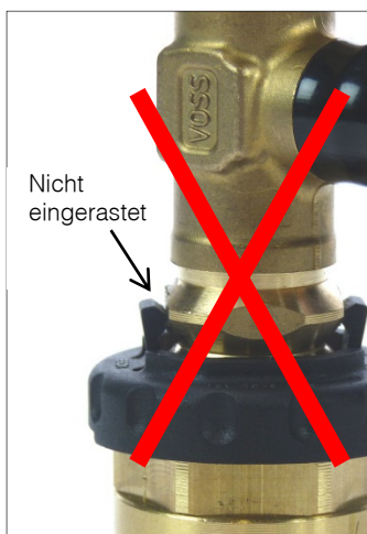
Abb. 5: Verdrehsicherung nicht eingerastet
