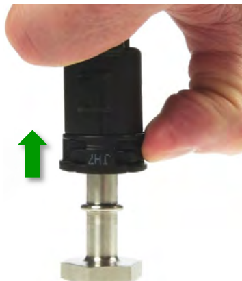
Abb. 25: Hochziehen der gelösten Kupplung 241 N
