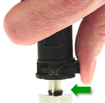
Abb. 36: Betätigen der Sekundärverriegelung (Wiederholmontage)
