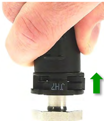
Abb. 17: Hochziehen der gesteckten Kupplung 241 N
