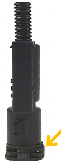
Abb. 5: Anlieferungszustand Stecksystem 241 N-SL Option 2: Halteklammer mit Sekundärverriegelung ist bündig mit dem Klammerkäfig
