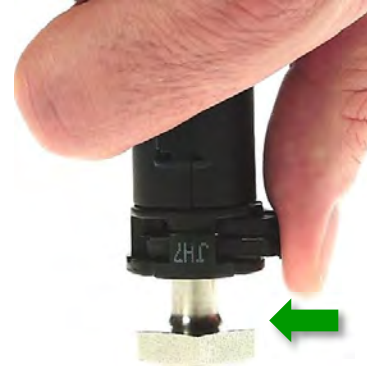
Abb. 15: Betätigen der Sekundärverriegelung
