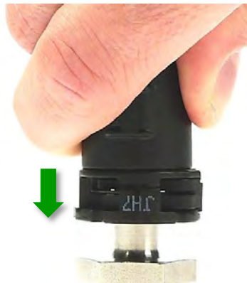
Abb. 21: Runterdrücken der Kupplung 241 N
